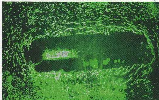
蛍光浸透探傷試験による割れの指示模様
