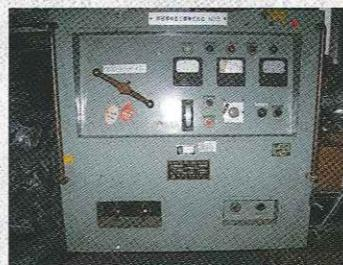
磁化・脱磁電源装置
