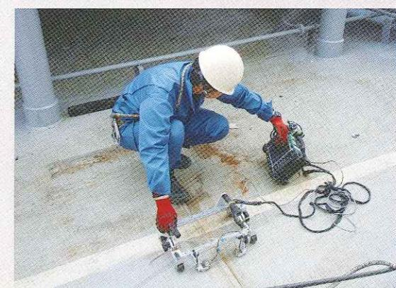
TOFD法の走査治具と専用超音波探傷器
