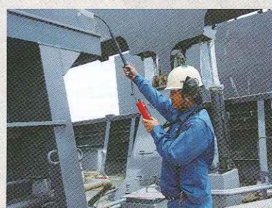
船倉溶接線の気密検査
