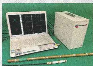
汎用器及び携帯型小型渦流探傷器
