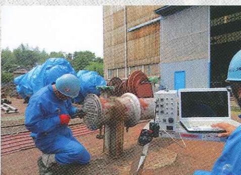
熱交換器伝熱管の検査風景
