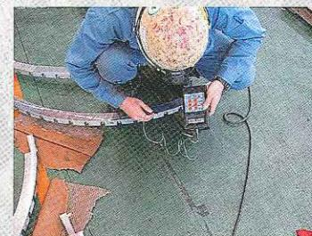
脱磁後に残留磁気を確認
