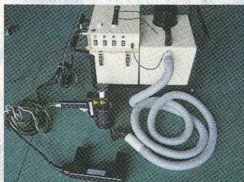
検査液攪拌、散布、廃液回収装置を備え一人作業での精度を確保しました。
