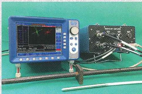
リモートフィールド渦流探傷装置
